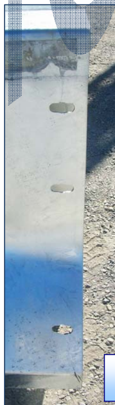
Fixation sur bloc DB80F Par trous oblong 18x50
